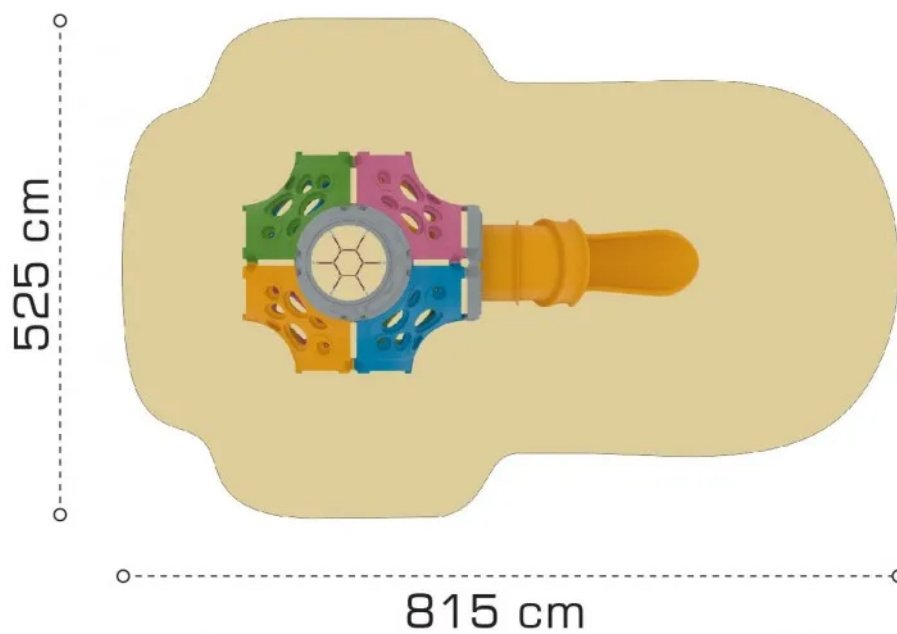
Rys. 2. Wymiary strefy bezpieczeństwa
