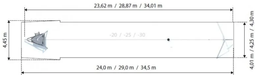
Rys. 1. Wymiary urządzenia i strefy bezpieczeństwa
